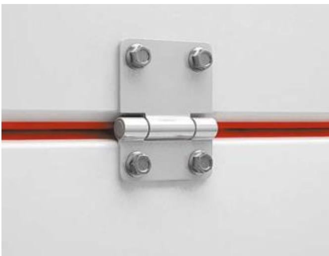
La conception spécifique des charnières intermédiaires avec axe et leur forme courbe assurent leur solidité et empêchent le fléchissement et la torsion des fixations. Les essais ont démontré qu'une seule charnière peut résister à une force de traction de près de 7000 Newton, soit  $\approx 715$  kg.
