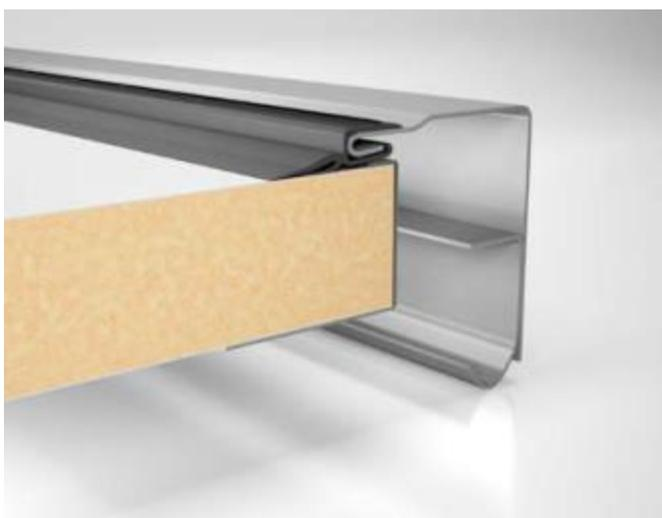
Les joints d'étanchéité supérieurs et latéraux sont conçus pour assurer l'adhérence étanche de la porte à la baie. La conception du joint double lèvres crée un réservoir d'air qui garantit une isolation thermique élevée et protège des déperditions de chaleur.
