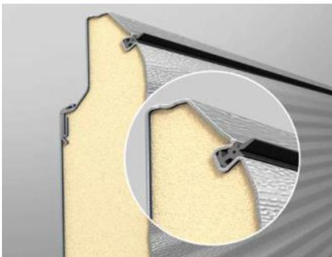
Les panneaux ALUTECH sont équipés d'un joint EPDM qui conserve résistance et élasticité même à basse température. Grâce à cela, aucun interstice ne se forme et vous bénéficiez d'une excellente isolation thermique et phonique.
