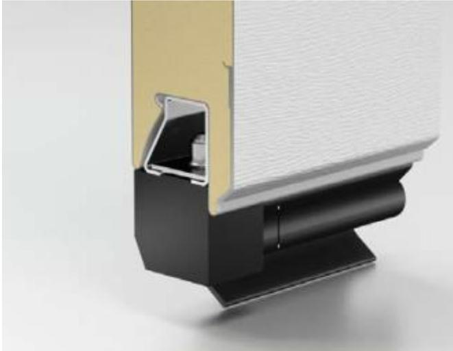
De par sa forme et ses propriétés ( élasticité, résis tance aux très basses températures ), le joint bas d'étanchéité permet de compenser des petites irrégularités éventuelles du sol et de garantir une étanchéité parfaite des parties basses au niveau du sol. Les bavettes d'arrêt empêchent tout excès de compression et préviennent ainsi le vieillissement prématuré du produit.
