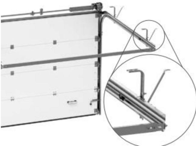
Ce type d'équerres simplifie la pose des rails de guidage et en facilite la fixation à la hauteur souhaitée.
